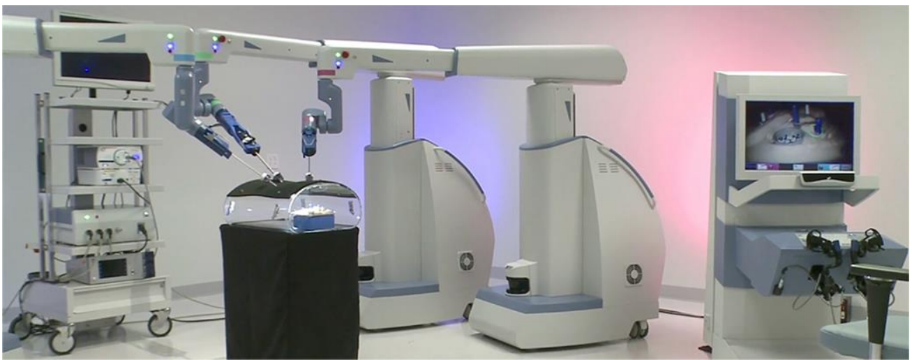
Εικόνα 1-13. Το ρομποτικό σύστημα Senhance (Telelar ALF-X) (Πηγή: https://transenterix.com/introducing-digital-laparoscopy/ ).
