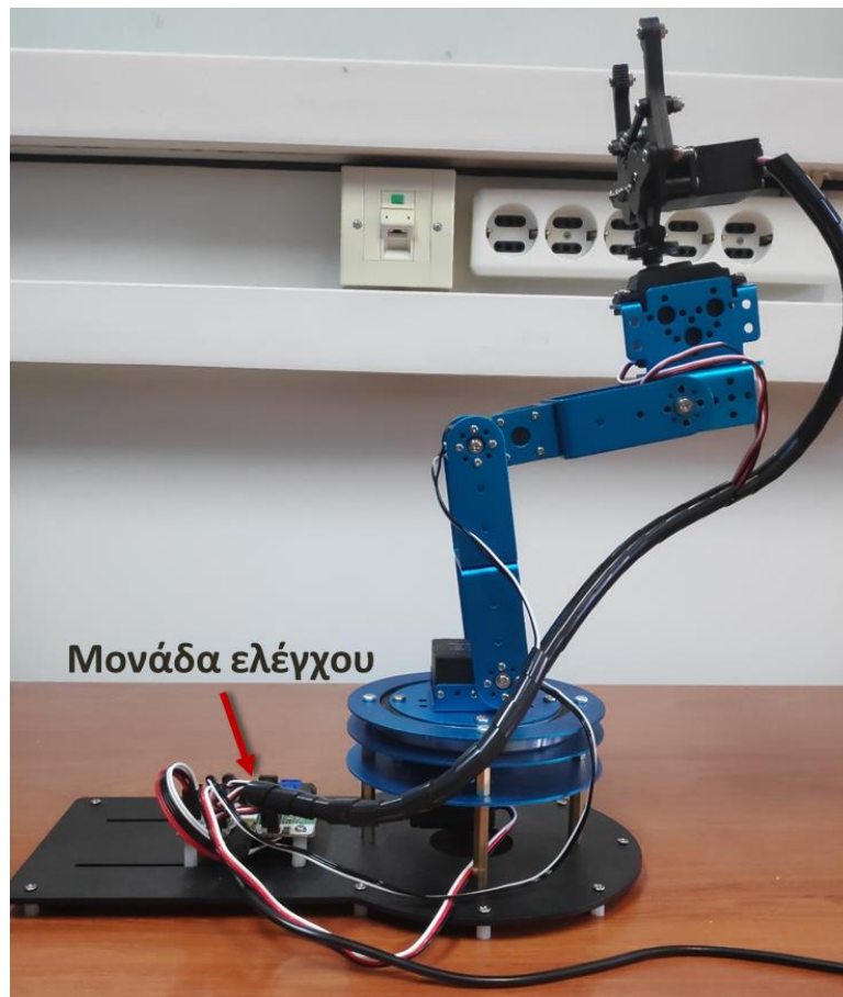
Εικόνα 1-29. Ρομποτικός βραχίονας όπου έχει σημειωθεί η μονάδα ελέγχου.
