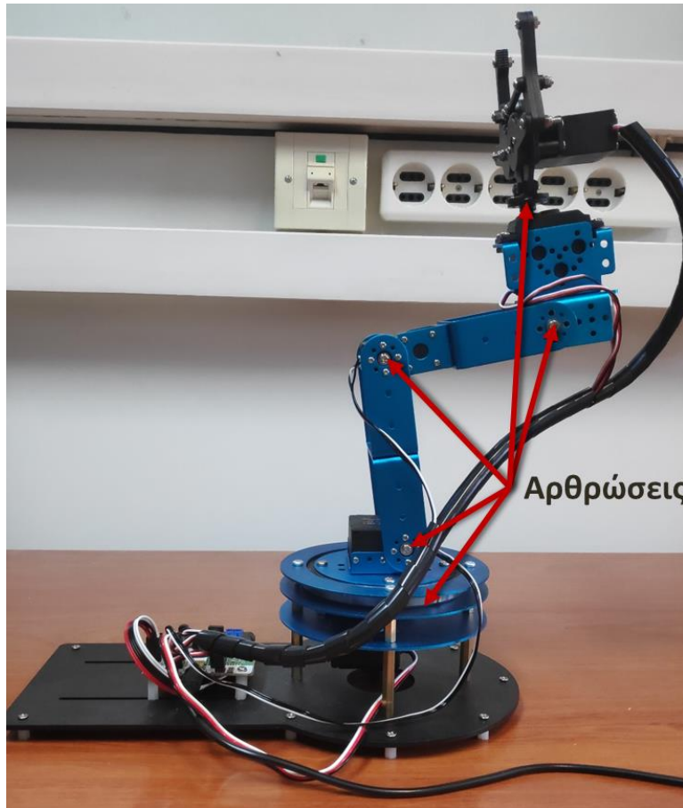
Εικόνα 1-24. Ρομποτικός βραχίονας όπου έχουν σημειωθεί οι αρθρώσεις του.
