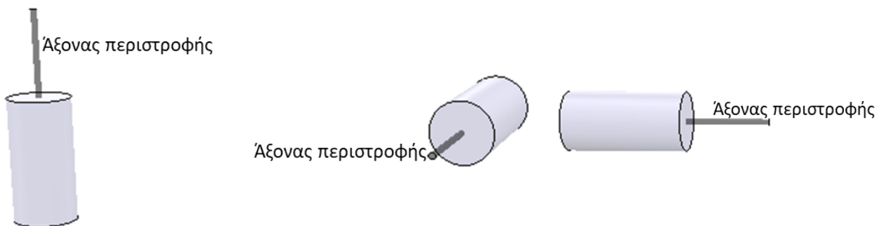
Εικόνα 4-3. Σύμβολο περιστροφικής άρθρωσης σε κινηματικό διάγραμμα σε διάφορους προσανατολισμούς. Ο άξονας περιστροφής συμπίπτει με τον άξονα του κυλίνδρου.
