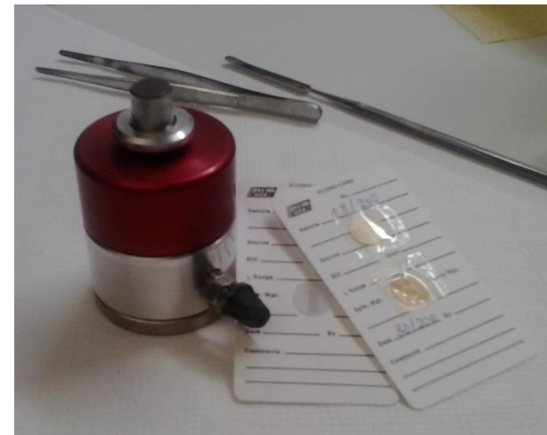
Διάταξη παρασκευής δισκίου KBr
