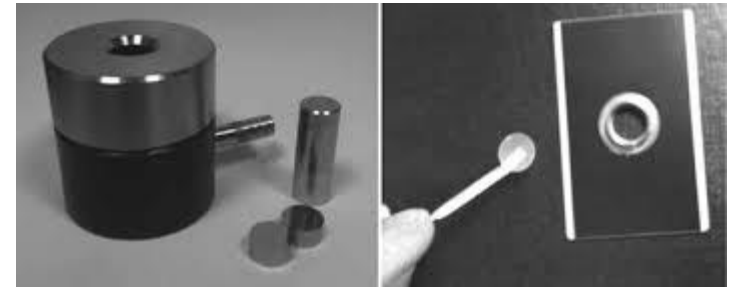
Διάταξη παρασκευής δισκίου KBr
