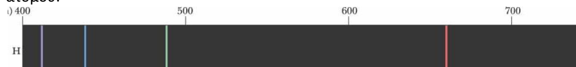
Σχήμα 2: Το φάσμα εκπομπής του ατόμου του Υδρογόνου στο ορατό.
