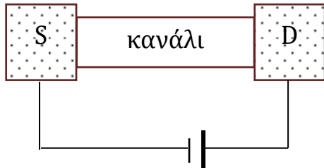
Σχήμα 1: Το transistor αποτελείται από μία ενεργό περιοχή που ονομάζεται κανάλι στα άκρα της οποίας έχουν δημιουργηθεί δύο επαφές που ονομάζονται source (πηγή) και drain (καταβόθρα).
