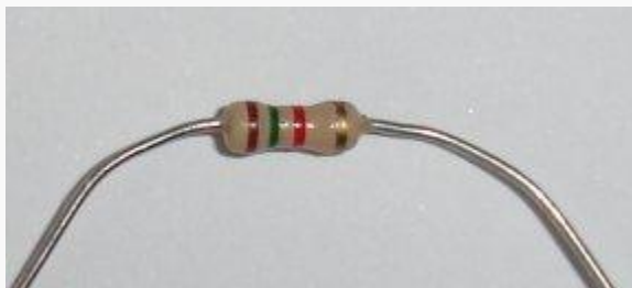
Ηλεκτρική αντίσταση άνθρακα, ονομαστικής τιμής 1,5 kΩ, 0.5 Watt.
