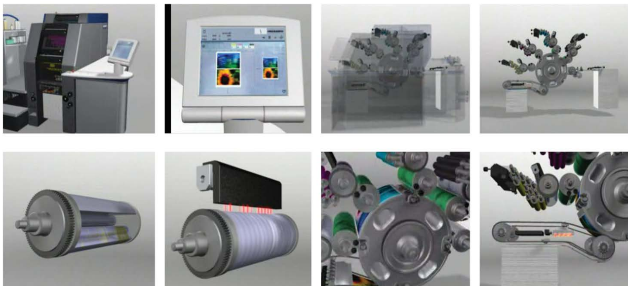
Εικόνα 2.7. Μηχανή Quick Master QM 46-4 DI της Heidelberg. Διακρίνονται η μεταφορά του θέματος από ψηφιακό αρχείο, η εγγραφή του στις πλάκες εκτύπωσης, τα μελανεία της και ο κύλινδρος πίεσης καθώς επίσης η διαδικασία καθαρισμού του θέματος και επανασχηματισμός νέου στην ίδια εκτυπωτική πλάκα
