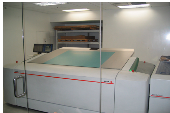
Εικόνα 2.2. αυτόματο εμφανιστήριο τσίγκων Agfa VLF 80 διαθέσιμο από http://www.viprofix.com/newlandingpages/agfa/agfa_xcalibur_vlf_80.html
