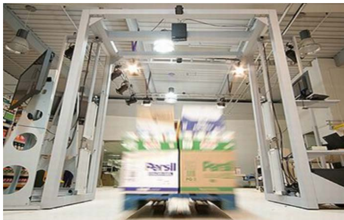
Εικόνα 3.2. Όρθιος αναγνώστης RFID στην αποθήκη υπερκαταστήματος
