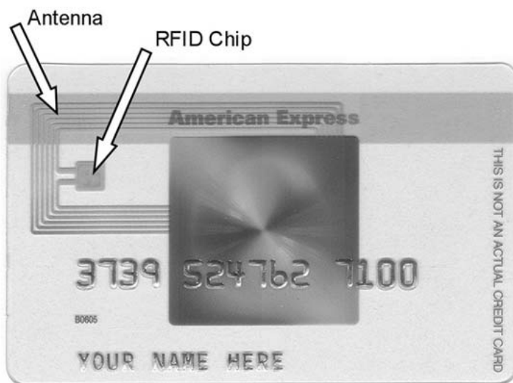
Εικόνα 3.1. Εφαρμογή κεραίας και ολοκληρωμένου κυκλώματος σε πιστωτική κάρτα
