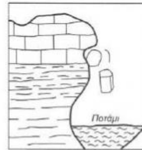
λόγω ρωγμών & διάβρωσης από το ποτάμι
