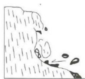
τυπική κατάπτωση βράχων
