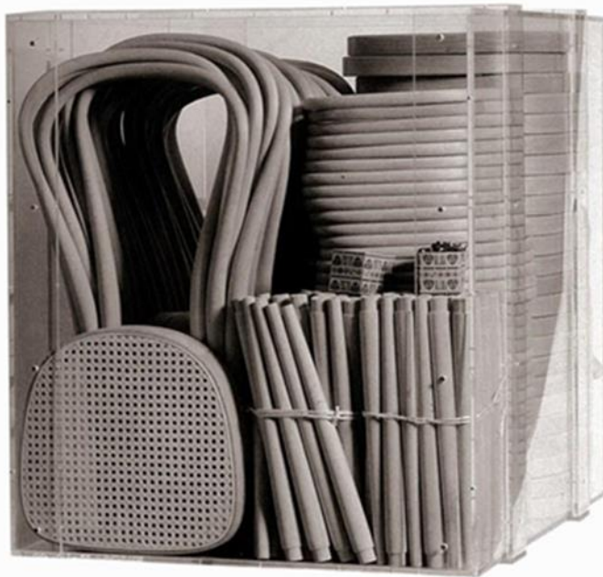
Εικ.30. Συσκευασία των τεμαχίων για 36 καρέκλες (μοντέλο No. 14, Thonet) σε ένα κυβικό μέτρο
