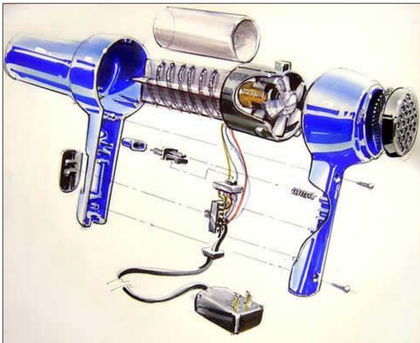
Εικ.156. Τρισδιάστατος σχεδιασμός στεγνωτήρα μαλλιών μέσω Η/Υ
