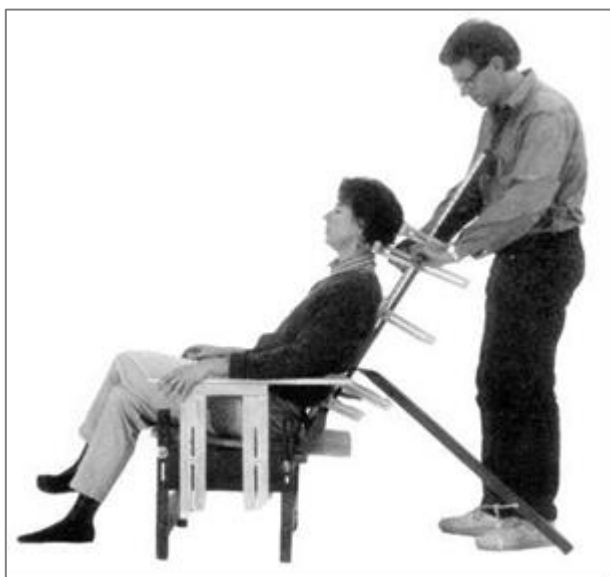
Εικ.184. Ρυθμιζόμενη κατασκευή για την εύρεση των σωστών, εργονομικά, διαστάσεων καρέκλας από τους John και Caroline Grew-Sheridan 61
