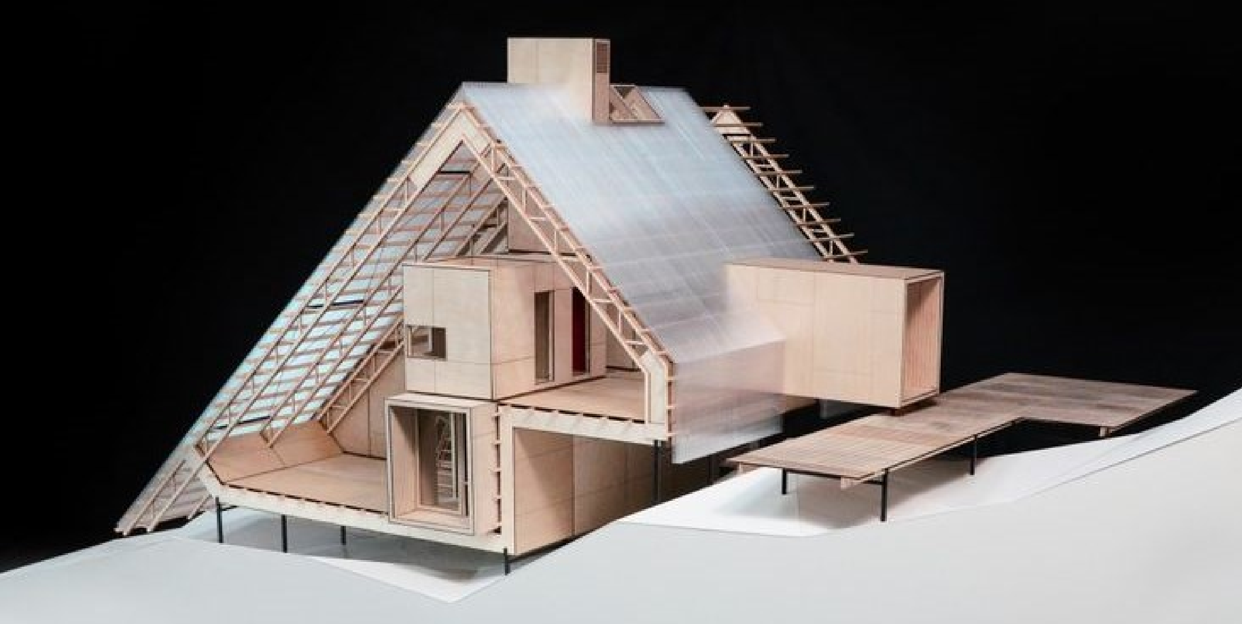
Μακέτα τομής, κατασκευαστική με οικοδομικές λεπτομέρειες
