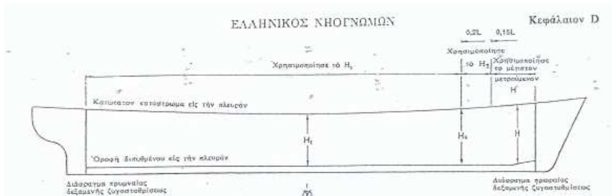
Σχ. D 7.1—τρόπος μετρήσεως τοῦ Η διὰ τοὺς κυρίους νομῆς λαμβανομένης ὑπ' ὄψιν τῆς σιμότητος τοῦ καταστρώματος.
