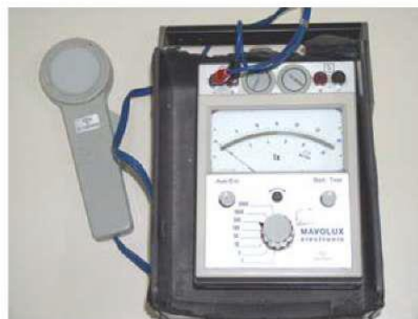
Σχήμα 5. Φωτόμετρο, συσκευή μέτρησης αναλογικού χαρακτήρα.
