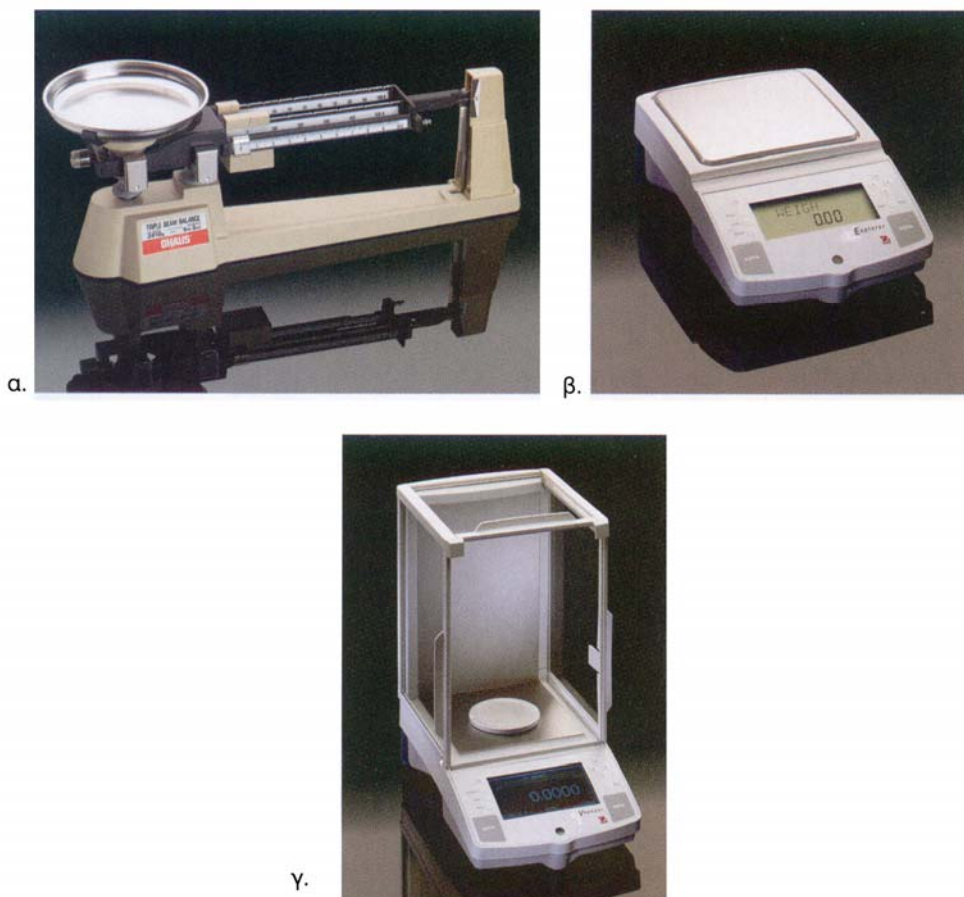
ΣΧΗΜΑ 12: α. Μηχανικός ζυγός τριπλής φάλαγγας ακρίβειας 0,1 g β. Ηλεκτρονικός ζυγός ακρίβειας 0,01 g γ. Αναλυτικός ζυγός υψηλής ακρίβειας 0,0001 g.
