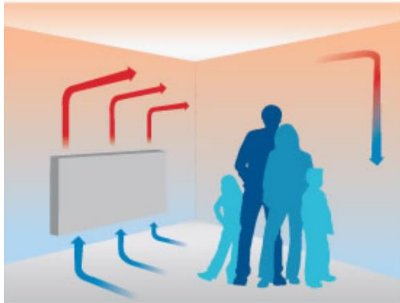
Παράδειγμα θέρμανσης μεταγωγής
