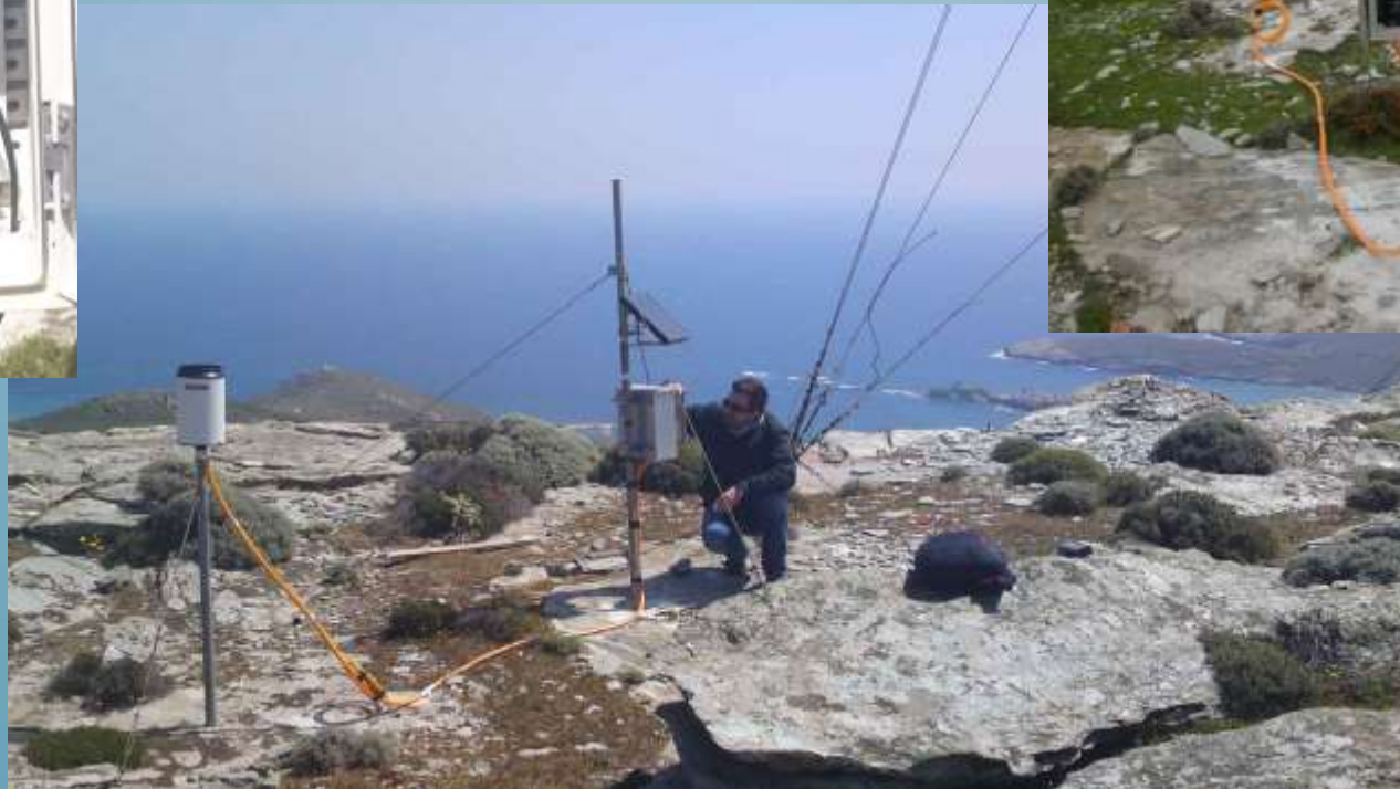
ΒΡΟΧΟΜΕΤΡΙΚΟΣ ΣΤΑΘΜΟΣ ΕΡΓΑΣΤΗΡΙΟΥ ΣΤΗΝ ΑΝΔΡΟ
