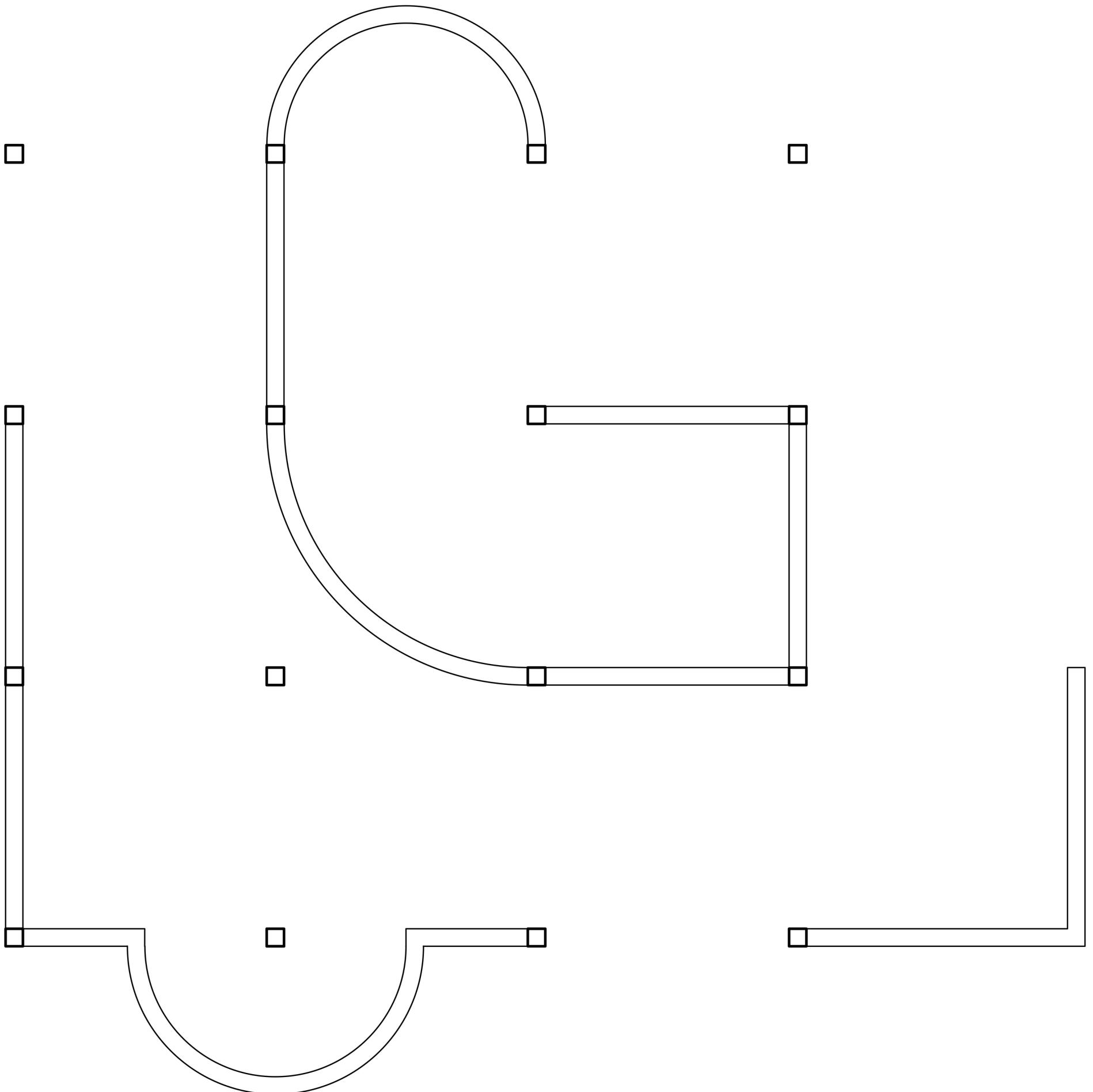
Σχεδιάστε την παραπάνω κάτοψη. Για να σχεδιάσετε τον κάνναβο των υποστηλωμάτων χρησιμοποιείστε την εντολή Array. Δώστε αριθμό σειρών (rows) και αριθμό στηλών (columns) = 4 και μεταξύ τους απόσταση (spacing) = 3.
