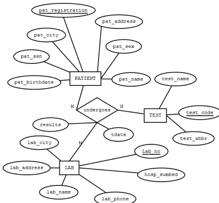
Εικόνα 5.11 Μοντέλο Οντοτήτων-Συσχετίσεων για το σύστημα νοσοκομείων. Οι εργαστηριακές εξετάσεις περιγράφονται από τριαδική συσχέτιση τύπου M:N:N
