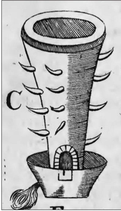
FIG. 2 A guayra (or huayra). Source: Book IV Chapter VI of Álvaro Alonso Barba's Arte de los metales, en que se enseña el verdadero beneficio de los de oro, y plata por azogue. El modo de fundirlos todos, y como se han de refinar, y apartar unos de otros (1640 [Lima 1817]).
