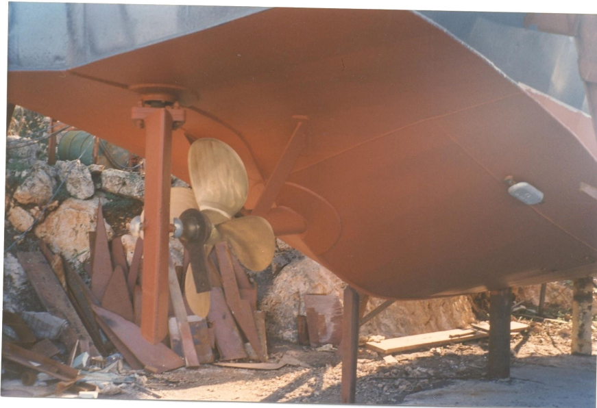
Τοποθέτηση στον πυθμένα του σκάφους και στην πλευρά ανοδίων για καθοδική προστασία της γάστρας.
