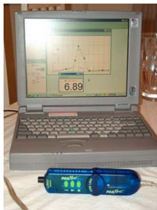
Εικόνα 2.: Φωτογραφίες από αισθητήρα (μεταλλάκτη) για την μέτρηση της έντασης φωτός, ο οποίος συνδέεται άμεσα με την θύρα USB του υπολογιστή.
