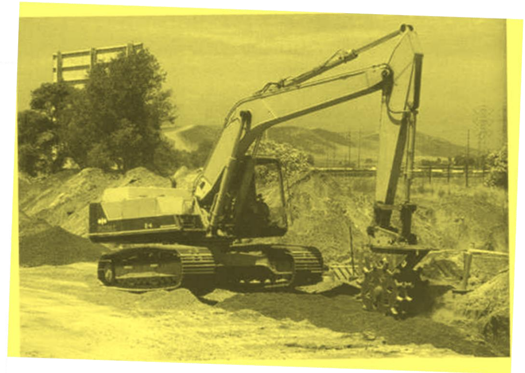
Εικόνα 19. Περιστροφική διάταξη διάσπασης λίθων/συσσωματωμάτων προσαρμοσμένη σε εκσκαφέα
