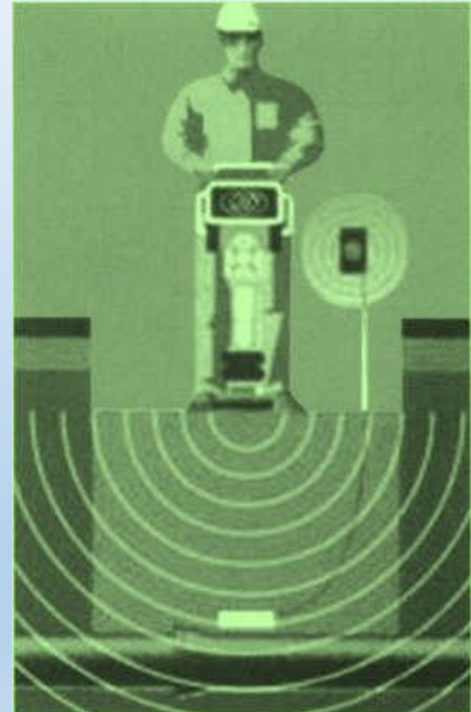
Σχήμα 60. Συμπύκνωση τάφρων από κρουστικό μηχάνημα.
