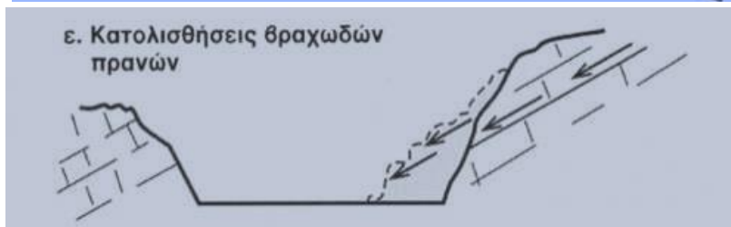
Σχήμα 93. Τύποι ολισθήσεων πρανών
