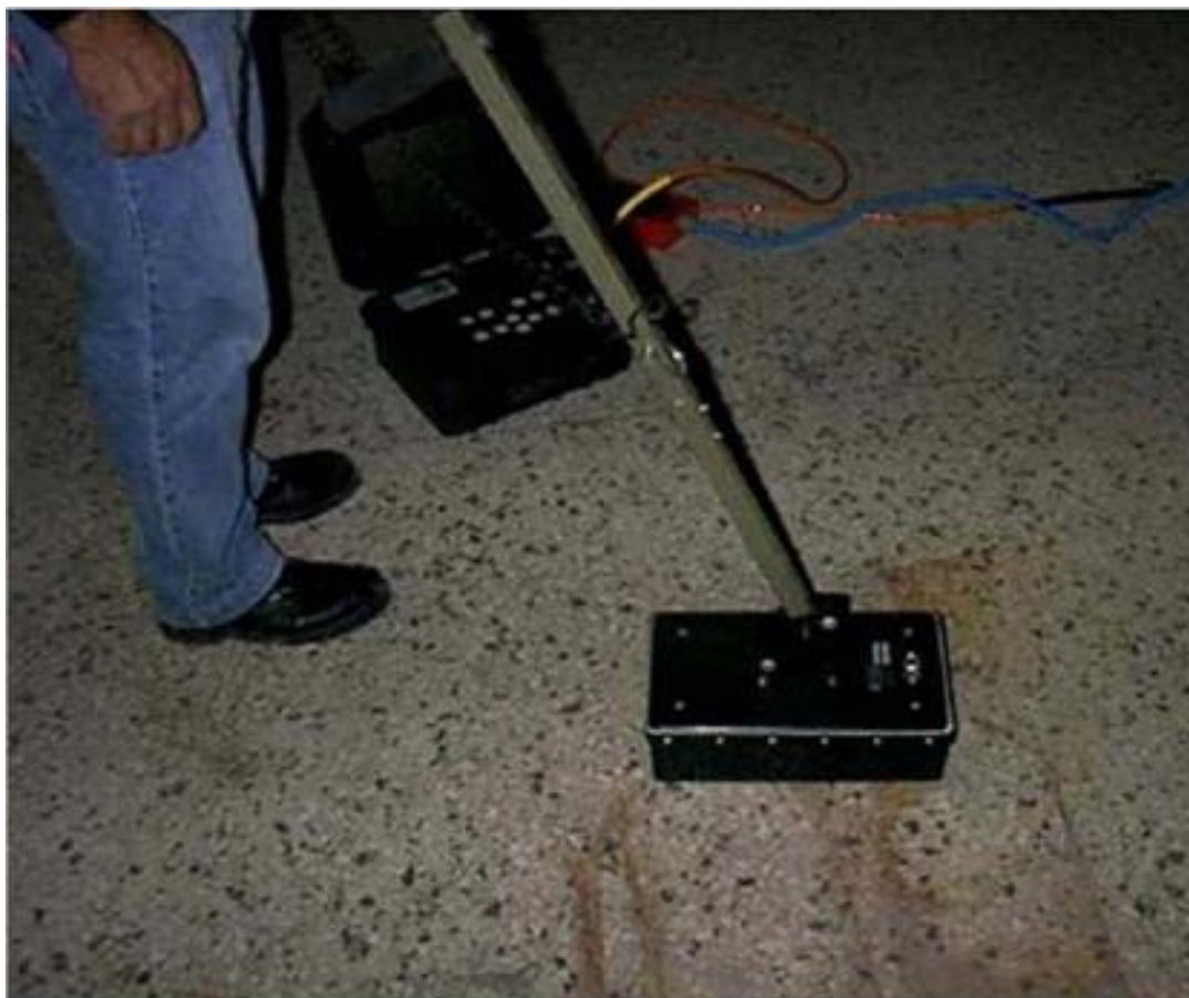
Αντένα Radar ( διακρίνεται και η κεντρική μονάδα)
