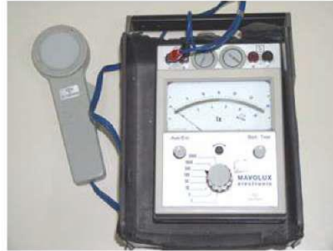
Σχήμα 5. Φωτόμετρο, συσκευή μέτρησης αναλογικού χαρακτήρα.
