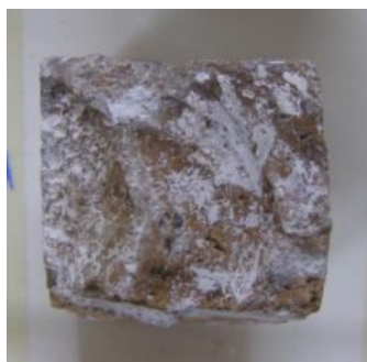
Εικόνα 8.1 Εργαστηριακό δοκίμιο κατεργασμένο με Calosil IP 25.
