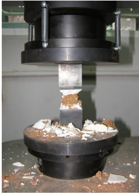
Εικόνα 6.6 Δοκίμιο κατά την διαδικασία μέτρησης αντοχής σε θλίψη.
