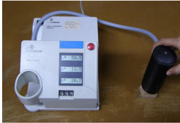
Εικόνα 6.4 Μέτρηση χρώματος με χρήση της συσκευής DR LANGE Labor – Ladestation LDC 20-II Micro Color II.
