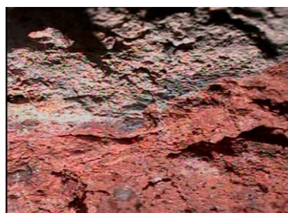
Εικόνα 4.6 Δείγμα 25A_1_Φ (x120) Παρατηρείται φυσική πάτινα.
