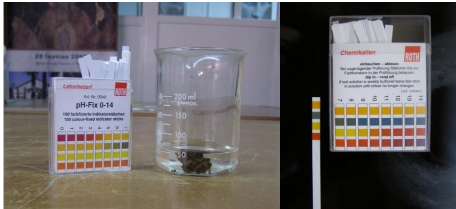
Εικόνα 5.7 Μέτρηση pH με τη χρήση pH-μετρικών ταινιών.
