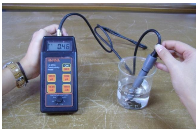
Εικόνα 5.6 Μέτρηση αγωγιμότητας με αγωγιμόμετρο HI 8733.
