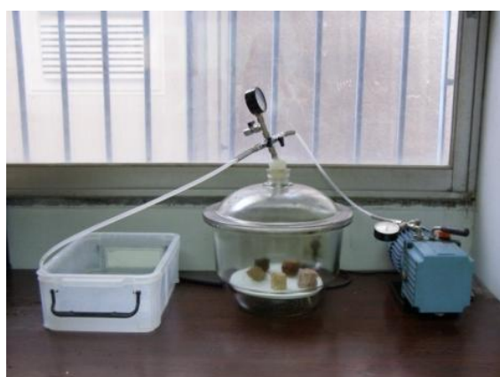
Εικόνα 6.1 Διάταξη της συσκευής, όπου μετρήθηκε το πορώδες των δοκιμίων σε υποκενό.
