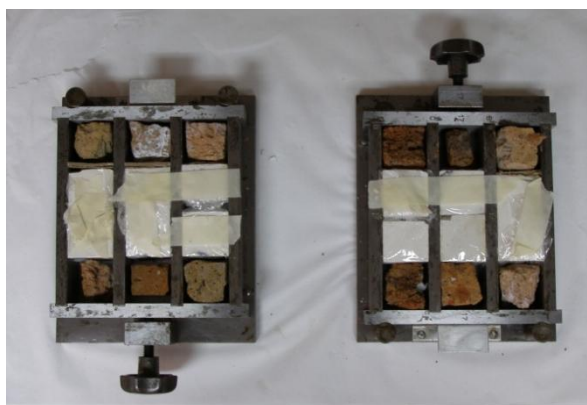
Εικόνα 6.5 Εγκιβωτισμός σε πρότυπες μήτρες διαστάσεων 4x4x4 cm.
