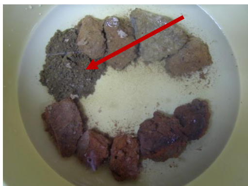
Εικόνα 10.3 Κατάρρευση κατεργασμένου δοκιμίου κατά τη διάρκεια κύκλων κρυστάλλωσης \text{Na}_2\text{SO}_4 .
