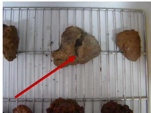
Εικόνα 10.2 Αστοχία κατεργασμένου δοκιμίου κατά τη διάρκεια κύκλων κρυστάλλωσης \text{Na}_2\text{SO}_4
