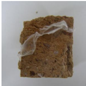
Εικόνα 8.2 Εργαστηριακό δοκίμιο κατεργασμένο με Funcosil 100.
