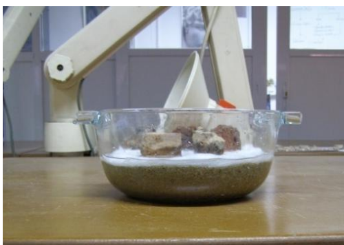
Εικόνα 6.2 Τα δοκίμια κατά την μελέτη του φαινομένου της τριχοειδούς αναρρίχησης.
