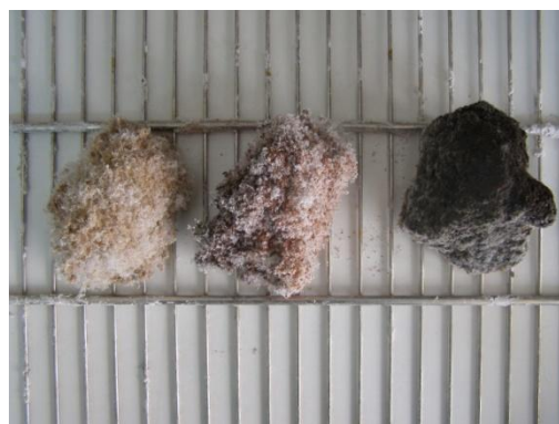
Εικόνα 10.4 Εξανθήσεις \text{Na}_2\text{SO}_4 στην επιφάνεια των δοκιμίων.
