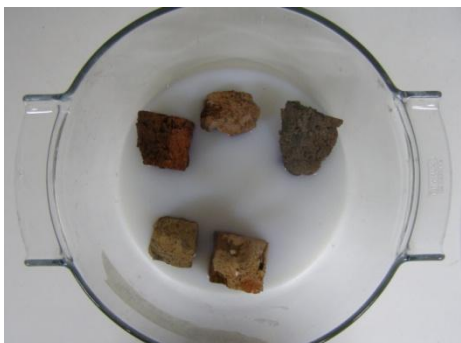
Εικόνα 7.1 Κατεργασία δοκιμίων με φυσική ρόφιση του στερεωτικού.
