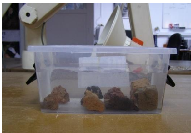
Εικόνα 6.3 Τα δοκίμια κατά την μελέτη του φαινομένου της υδαταπορρόφησης.
