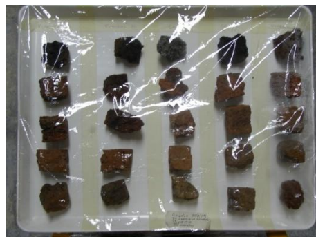
Εικόνα 7.2 Τα δοκίμια κατά τη διάρκεια της εξάτμισης του διαλύτη των στερεωτικών.
