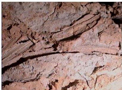
Εικόνα 4.4 Δείγμα 60A_1_E (x80) Παρατηρούνται ίχνη από άχυρο.
