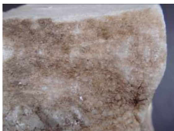
Σχήμα 7.145. ΑΚ 4406. Περιοχή 1 μετά τον καθαρισμό με Laser, macro-φωτογράφιση
