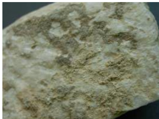
Σχήμα 2.30. AK 4051. Αποθέσεις στην επιφάνεια του μαρμάρου. Παρουσιάζουν συνοχή και πρόσφυση στην υποκείμενη επιφάνεια.
