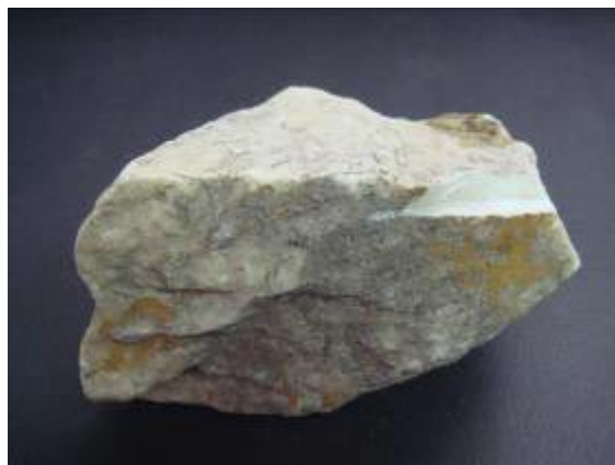
Σχήμα 3.8. ΑΚ 4061. Λήψη δείγματος διαστάσεων 0,5εκ. x 1εκ. από την επιλεγείσα περιοχή για μικροσκοπική παρατήρηση
