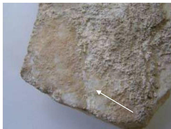
Σχήμα 7.84. AK 5103. Δείγμα μετά τον καθαρισμό, διακρίνεται περιοχή υπερκαθαρισμού
