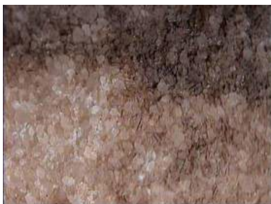
Σχήμα 7.159. AK 5110. Δείγμα μετά τον καθαρισμό με Laser. Όρια περιοχής 5 (αριστερά), 4 (δεξιά) και περιοχής πριν τον καθαρισμό (πάνω). Στερεοσκοπική παρατήρηση x6,7
