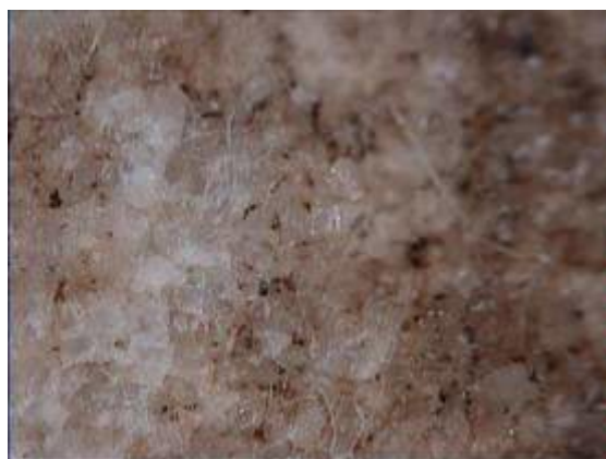
Σχήμα 7.182. ΑΚ 4408. Περιοχή 1 μετά την εφαρμογή επιθέματος σεπίόλιθου για 30 λεπτά. Παρατήρηση στο στερεομικροσκόπιο
