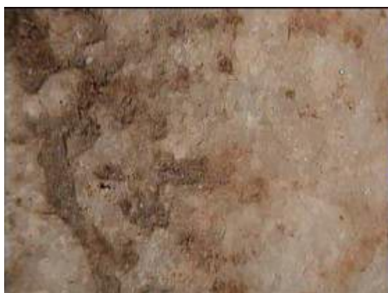
Σχήμα 7.14. Όρια περιοχής καθαρισμού. Στερεομικροσκόπιο X 6.7. Παρατηρούνται ίχνη των αποθέσεων.
