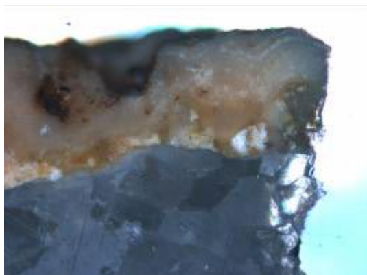
Σχήμα 5.55. AK 3939. Οπτικό μικροσκόπιο x50, Χ Νicols. Διακρίνονται τα στρώματα των αποθέσεων και οι χαρακτηριστικές φυλλώσεις
