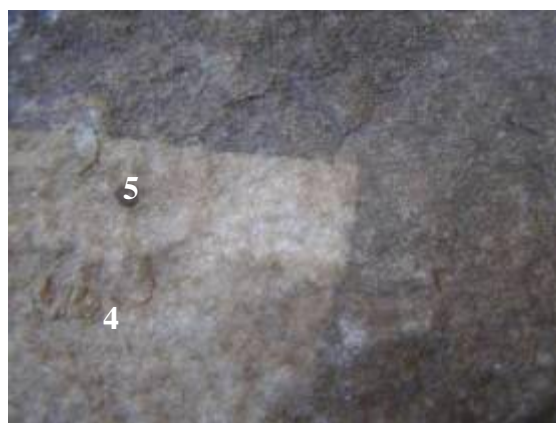
Σχήμα 7.154. AK 5110. Δείγμα μετά τον καθαρισμό με Laser. Διακρίνονται οι δύο περιοχές (4 και 5) καθαρισμού
