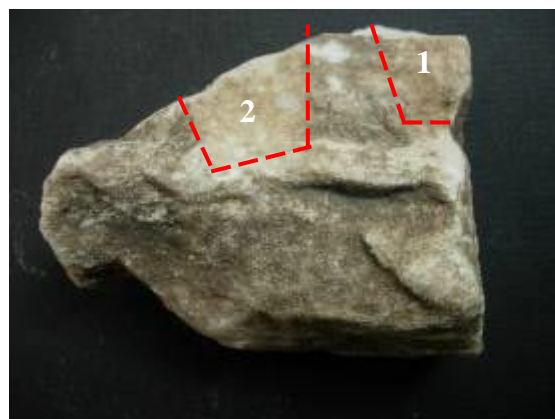
Σχήμα 7.142. ΑΚ 4406. Περιοχές 1 και 2 μετά τον καθαρισμό με Laser, οπίσθια όψη
