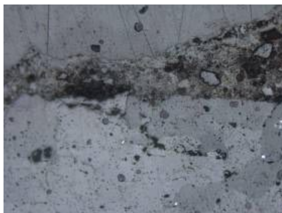
Σχήμα 5.10. AK 4014. Ίδια θέση, // Nicols. Παρατηρούνται μικροί κόκκοι εγκλωβισμένοι στα στρώματα αποθέσεων
