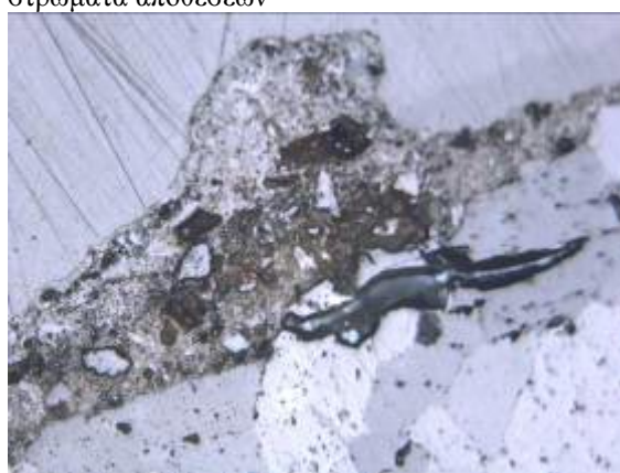
Σχήμα 5.12. AK 4014. Ίδια θέση, // Nicols. Διακρίνονται τα δύο στρώματα αποθέσεων καθώς και εγκλωβισμένοι κόκκοι στο ενδιάμεσο
