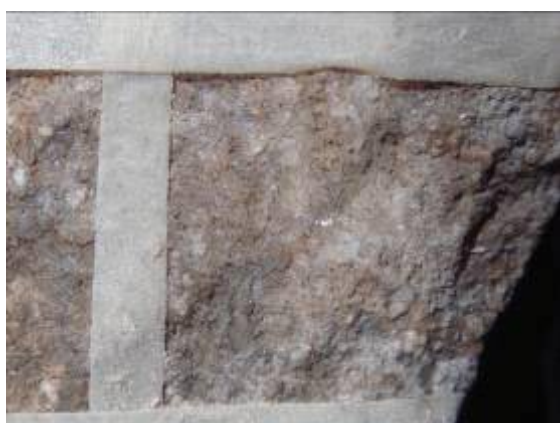
Σχήμα 7.177. AK 4408. Περιοχή 2 μετά την εφαρμογή επιθέματος τύπου Moira για 15 λεπτά. Μακροσκοπική παρατήρηση
