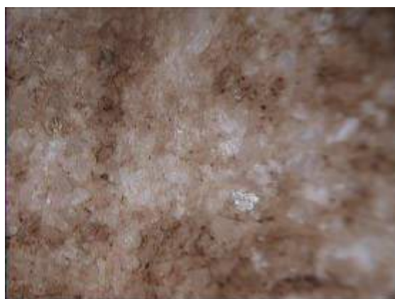
Σχήμα 7.184. ΑΚ 4408. Περιοχή 4 μετά την εφαρμογή επιθέματος τύπου Moga για 1 ώρα. Στερεοσκοπική παρατήρηση
