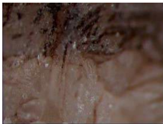
Σχήμα 7.156. AK 5110. Δείγμα μετά τον καθαρισμό με Laser. Όρια περιοχής 5 και περιοχής πριν τον καθαρισμό. Στερεοσκοπική παρατήρηση x45
