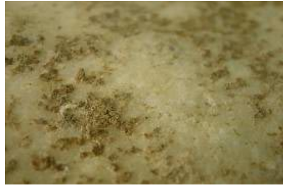
Σχήμα 7.139. ΑΚ 3480. Περιοχή στην οποία πραγματοποιήθηκε καθαρισμός με ζέστρο υπερήχων παρουσία νερού, μετά την εφαρμογή επιθέματος τύπου Mora.
