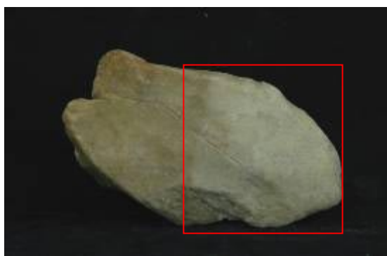
Σχήμα 7.231. ΑΚ 2559. Δοκιμή καθαρισμού με τη χρήση ατμοβολής. Διακρίνεται το αποτέλεσμα του καθαρισμού στη δεξιά πλευρά του θραύσματος.
