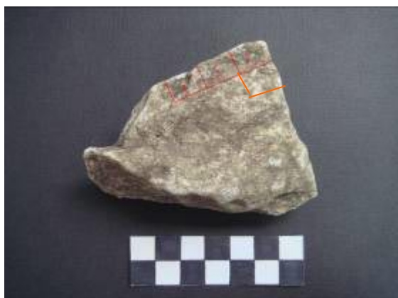
Σχήμα 7.167. ΑΚ 4406. Γενική εικόνα δείγματος, περιοχές δοκιμών καθαρισμού με επιθέματα
