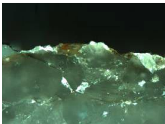
Σχήμα 7.20. AK 4014. Περιοχή καθαρισμού 1. Υπολείμματα αποθέσεων μετά τον καθαρισμό. Οπτική μικροσκοπία x50, X Nicols
