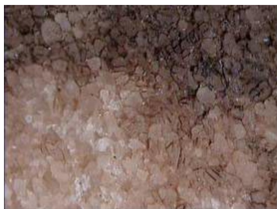
Σχήμα 7.160. AK 5110. Δείγμα μετά τον καθαρισμό με Laser. Όρια περιοχής 5 (αριστερά), 4 (δεξιά) και περιοχής πριν τον καθαρισμό (πάνω). Στερεοσκοπική παρατήρηση x6,7
