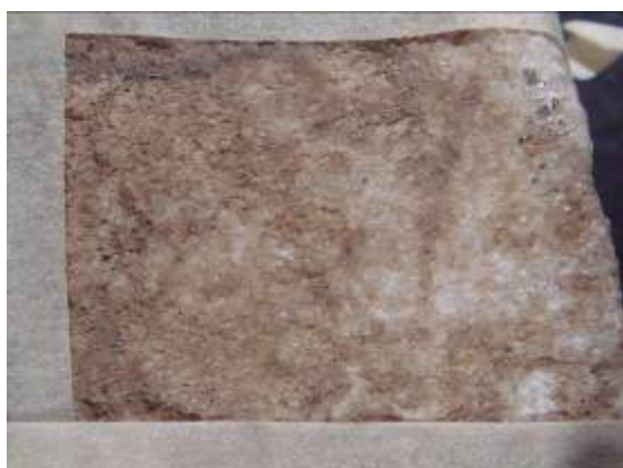
Σχήμα 7.183. ΑΚ 4408. Περιοχή 4 μετά την εφαρμογή επιθέματος τύπου Moga για 1 ώρα. Μακροσκοπική παρατήρηση.
