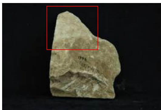
Σχήμα 7.232. ΑΚ 1346. Δοκιμή καθαρισμού με τη χρήση ατμοβολής. Διακρίνεται το αποτέλεσμα του καθαρισμού στην άνω πλευρά του θραύσματος.
