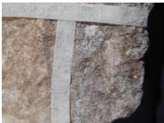
Σχήμα 7.179. ΑΚ 4408. Περιοχή 3 μετά την εφαρμογή επιθέματος τύπου Moga για 30 λεπτά. Μακροσκοπική παρατήρηση. Η περιοχή αριστερά είναι η περιοχή 4 στην οποία το επίθεμα έδρασε για μία ώρα
