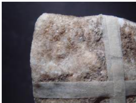
Σχήμα 7.170. ΑΚ 4406. Περιοχή 1 μετά τον καθαρισμό, επέμβαση με σεπίόλιθο, χρόνος εφαρμογής 30 λεπτά
