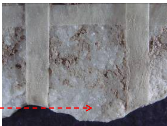
Σχήμα 7.33. ΑΚ 4434. Επιφάνεια μετά την εφαρμογή του επιθέματος. Απομακρύνονται ακόμα περισσότερο οι αργιλοπυριτικές αποθέσεις
