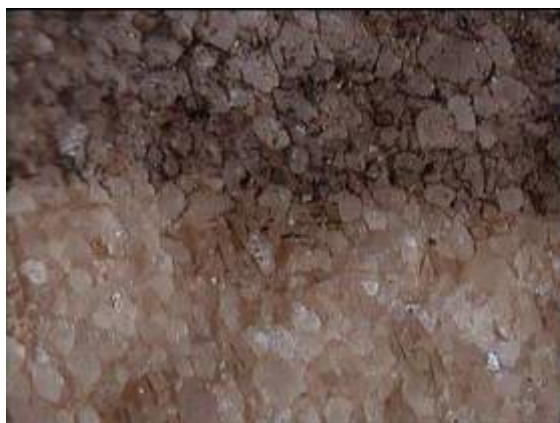
Σχήμα 7.155. AK 5110. Δείγμα μετά τον καθαρισμό με Laser. Όρια περιοχής 5 και περιοχής πριν τον καθαρισμό. Στερεοσκοπική παρατήρηση x10.
