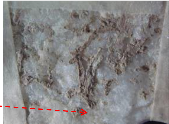
Σχήμα 7.35. AK 4434. Επιφάνεια μετά τον καθαρισμό. Αποθέσεις μεγαλύτερου πάχους δεν απομακρύνθηκαν
