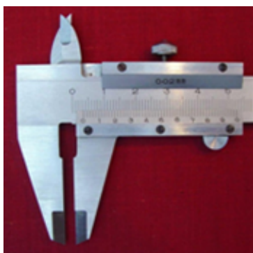
Εικόνα 3. Φωτογραφία του διαστημόμετρου με κλίμακα βερνιέρου.
